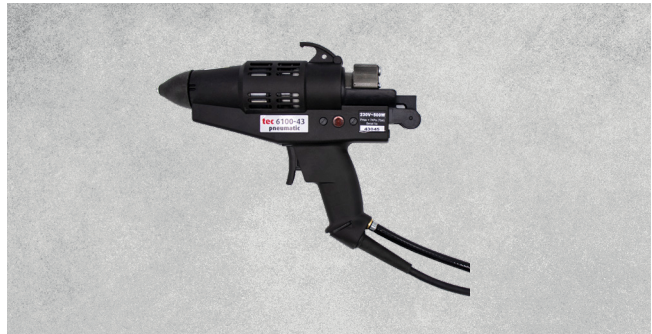
Limpistol TEC 6100, pneumatisk Smälthastighet: 4.1 kg/h. Limstorlek: 43 mm limpatron. Watt: 500 W. Kabel- och slanglängd: 3 m.
