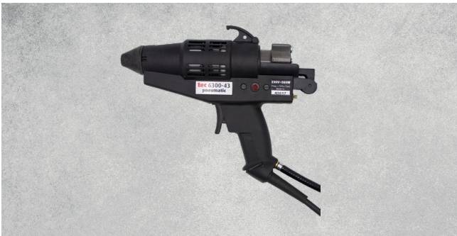
Limpistol TEC 6300, pneumatisk för spraylimning Smälthastighet: 4.2 kg/h. Limstorlek: 43 mm limpatron. Watt: 500 W. Kabel- och slanglängd: 3 m.
